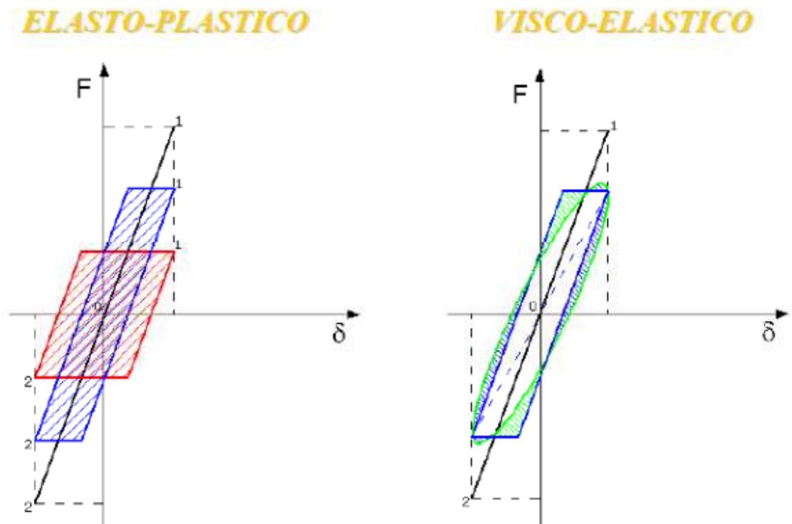
Essendo quindi la dissipazione proporzionale alla velocità del sistema non potrà essere uguale per tutte le strutture, ma avrà una diversa formulazione in virtù del periodo proprio principale della struttura e quindi della sua velocità di vibrazione. Si dovrà cioè considerare il valore del periodo proprio del sistema non lineare dato da  $T_m = \frac{2\pi}{\omega_m}$  (1.10) e quindi comparare questo valore con i valori  $T_B$  e  $T_C$  dello spettro elastico dello stato limite indagato.
