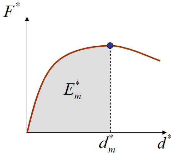
La lettura della curva evidenzia una parte iniziale sostanzialmente retta che ricalca il comportamento di un oscillatore semplice considerato in campo lineare, ma a mano a mano che l'oscillatore entra in campo plastico si avranno degli spostamenti che cresceranno rapidamente a fronte di una forza che invece resta quasi invariata in intensità.
