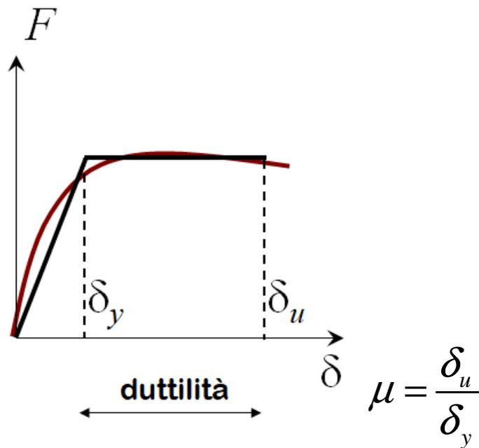
Oggi quando progettiamo agli Stati Limite ammettiamo che la struttura possa deformarsi, anche permanentemente, sotto azioni di notevole entità senza che si arrivi al collasso. Ammettiamo, quindi, che rimanga in campo elastico per una quota parte dell'azione sismica, affidando alle sue capacità deformative in campo plastico, quindi alla duttilità, l'onere di sopportare la restante parte.
