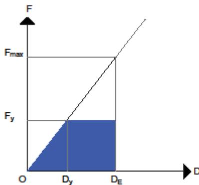
Questo principio prende il nome di “*principio di uguale spostamento*” e, come detto, è valido per strutture che presentano un periodo proprio in campo anelastico  $T^* = T_m = \frac{2\pi}{\omega_m}$  (1.14) che supera il valore  $T_C$  dello spettro elastico di progetto.
