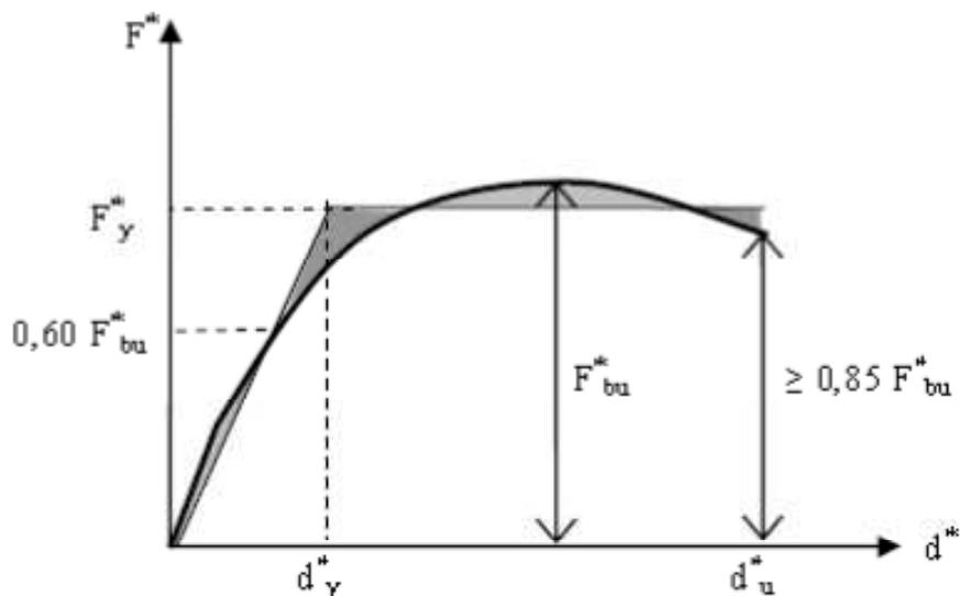
Prendiamo adesso in considerazione il diagramma rappresentativo del comportamento di un sistema SDOF in campo elastico.
